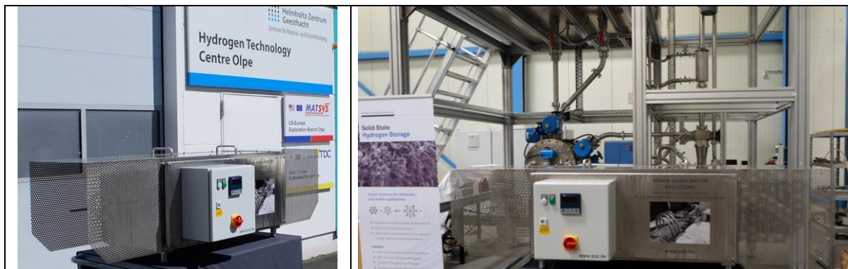
H2-Tank System B4S-SM am ZTC in Olpe sowie innen im Helmholtz HZG - Hydrogen Technology Centre vor dem Simoloyer ® CM100-s2 zur Herstellung komplexer Metallhydride
