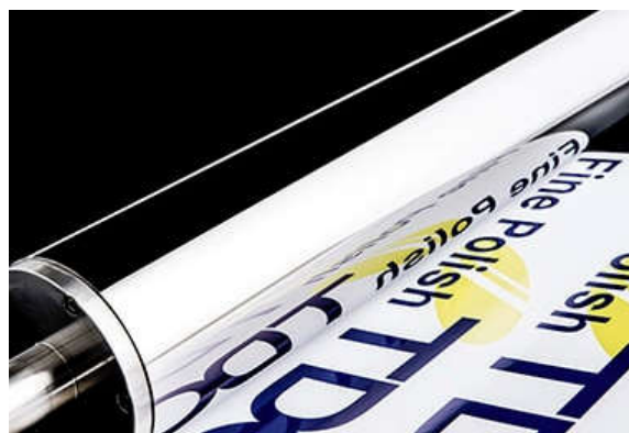
図2: 鏡面研磨ロール
