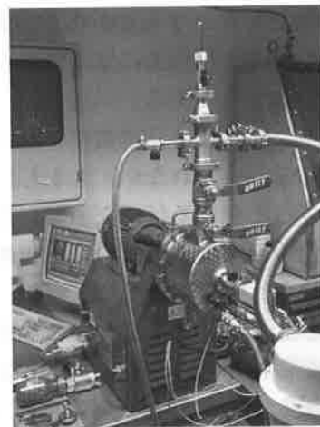
写真-3 Simoloyer® CM01-2lm 実験用に特化したモデル
