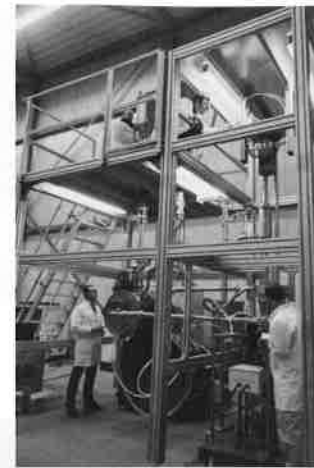
写真-5 Simoloyer® CM100-s2 全自動連続運転大容量モデル
